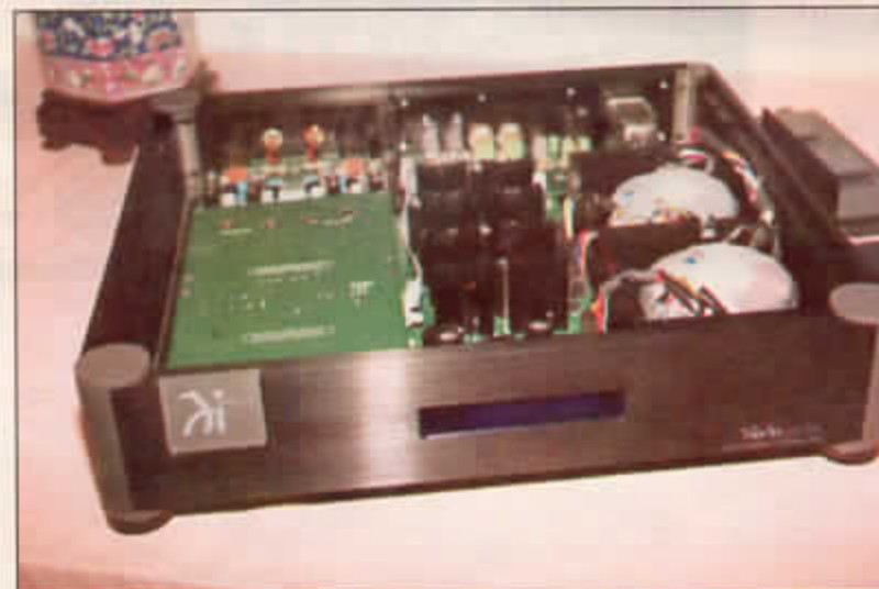
WADIA 17, o superdescodificador digital/analógico já preparado par o que der e vier: 24 bits/96kHz
