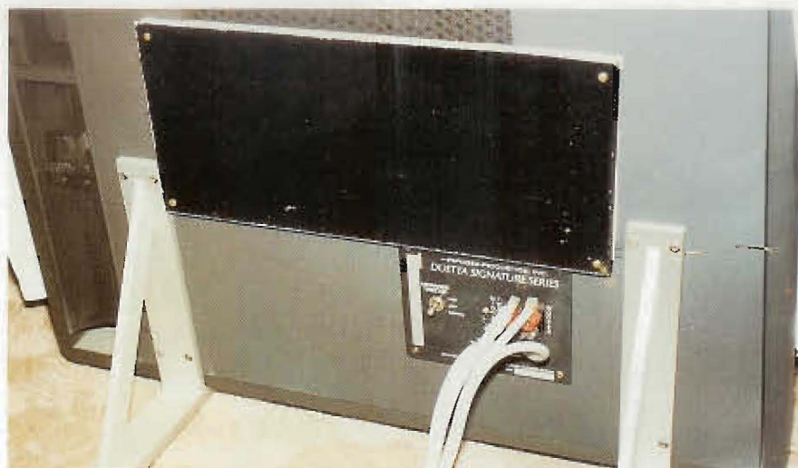
Painel de madeira colocado na base do painel posterior de graves para corrigir a interacção com a ressonância da sala
